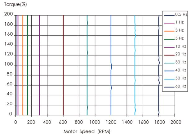
附PG電流向量模式可達零速200%轉矩輸出。
